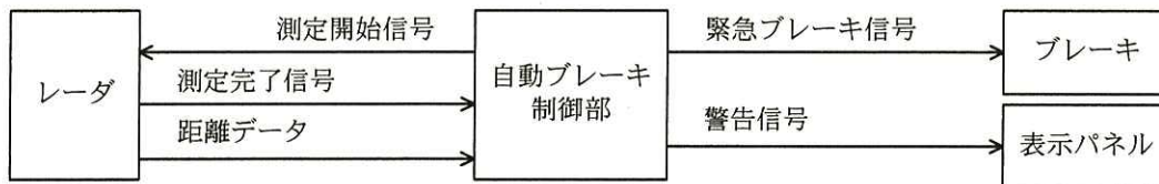
図2 自動ブレーキの構成
